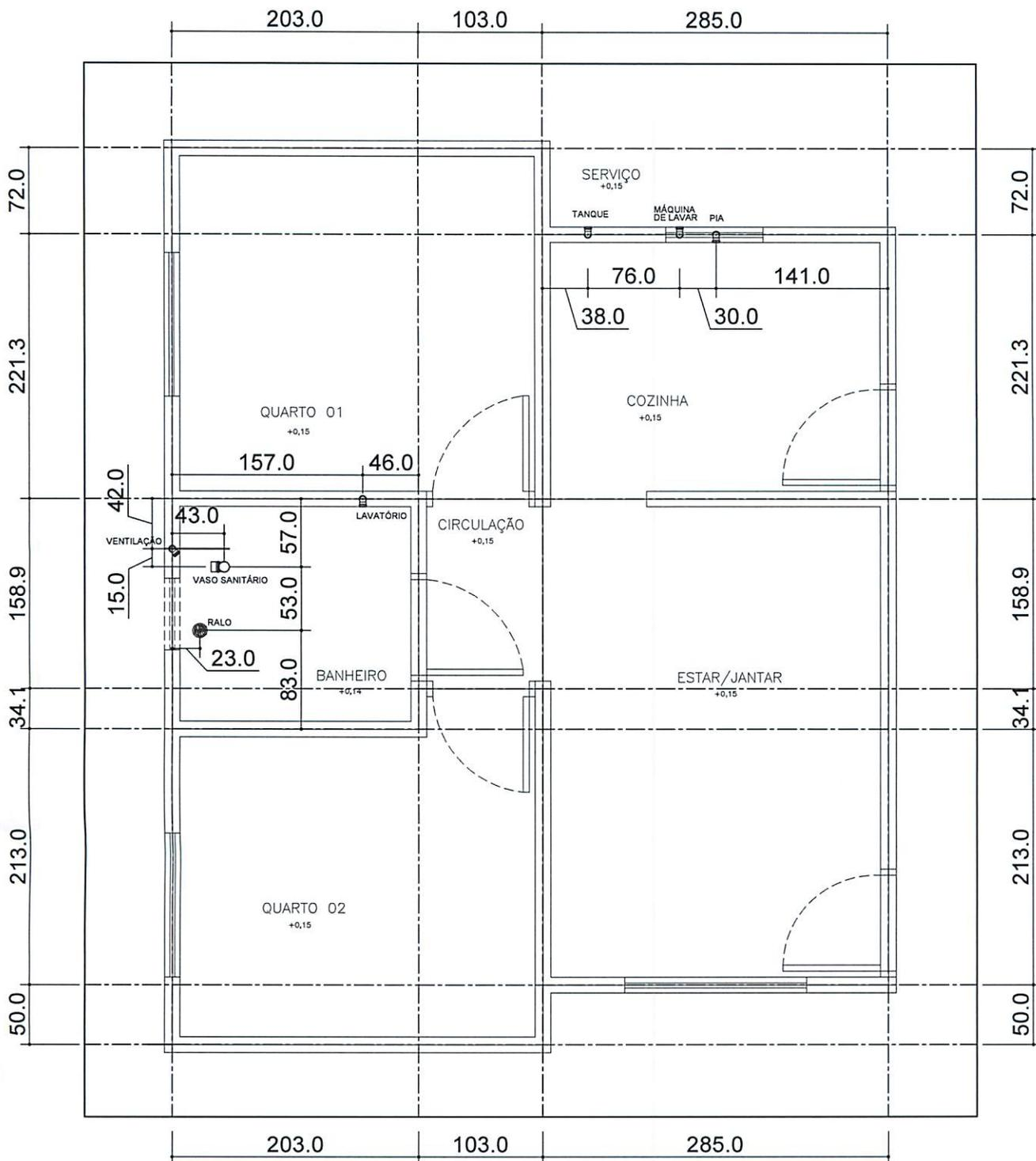
Planta de Locação das Paredes (13cm) - EIXO
